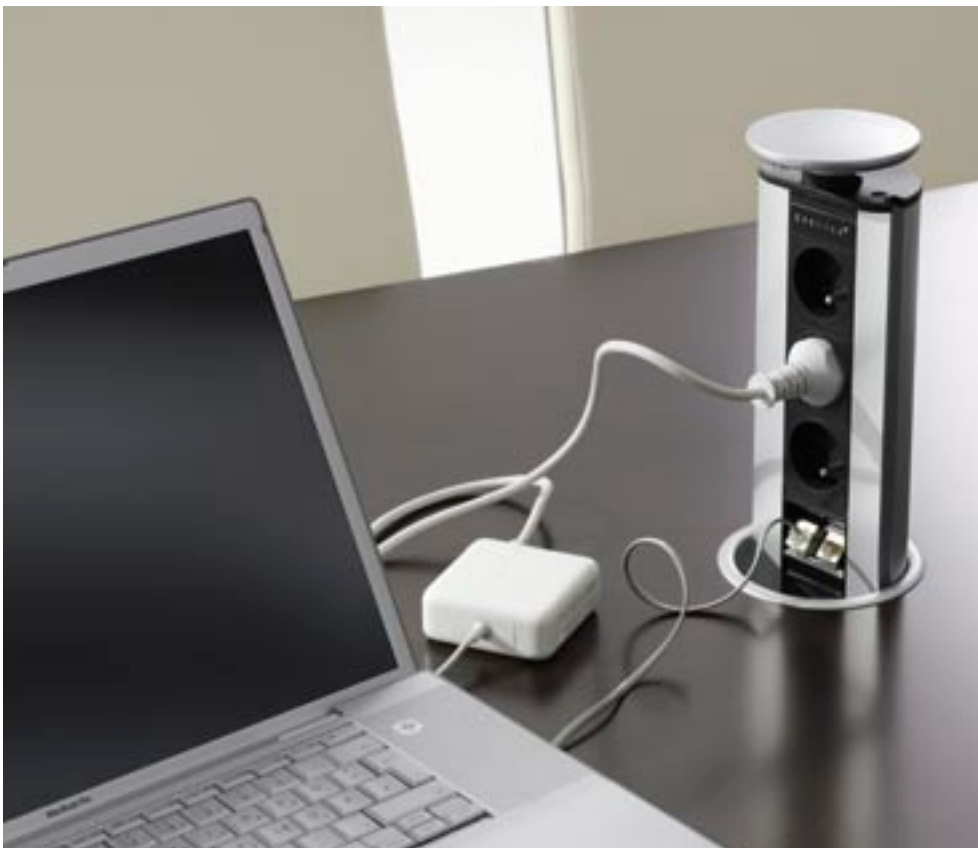
Der Port EVOLINE wird in der Tischplatte verbaut. Er hat ein Auszugssystem und tritt in vielen Systemkombinationen auf (unterschiedliche Zahl von Strom, Medien- und Internetanschlüssen). Der auf dem Bild dargestellte Port EVOLINE hat drei 230-V-Anschlüsse und zwei Anschlüsse RJ45 für den Internetzugang.
